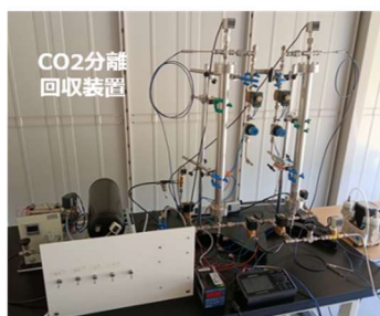
CO 2 分離回収装置
