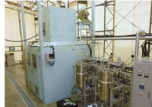
H 2 チャンバー内部に酢酸発酵槽を設置
