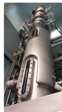
H 2 を高効率で供給する気泡塔型酢酸発酵槽
