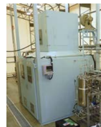
H 2 /CO 2 を基質とする酢酸発酵装置を安全に運用するための水素チャンバー
