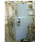
H<sub>2</sub>/CO<sub>2</sub>を基質とする酢酸発酵装置を安全に運用するための水素チャンバー
